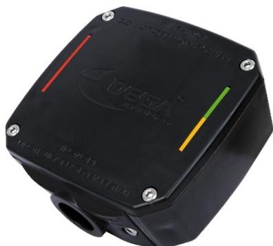
Der NB III Gaswarn-/Kältemitteltransmitter ist Teil eines Überwachungssystems. Der Transmitter kann an die Zentrale UKA III angeschlossen werden und ist mit einer analogen Schnittstelle (4-20mA) und einer digitalen Schnittstelle (RS485-DEGA) ausgestattet und kann darüber an die Zentralen UKA III, UPA III und UDA III angeschlossen werden. An die UKA III Zentrale können max. 8 Transmitter angeschlossen werden. Zudem ist es möglich einen Überschwemmungssensor und einen Temperatursensor
