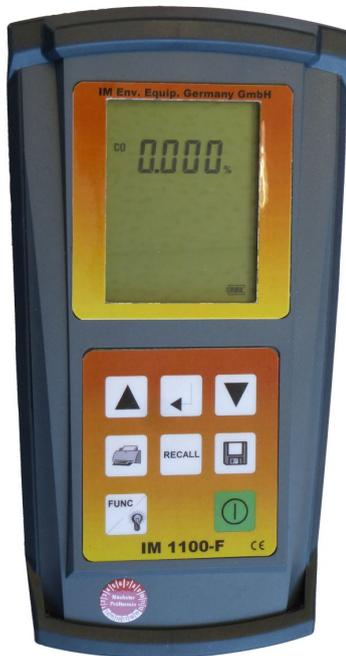
Das Abgasanalysegerät **IM 1100F** wird zur CO-Messung an Fahrzeugen mit Flüssiggas-Verbrennungsmotor gemäß §§ 33 und 37 UVV "Verwendung von Flüssiggas" (DGUV79 / ehemals BGV D34) eingesetzt.
