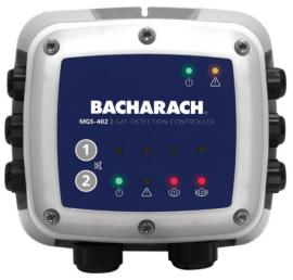
An die Kältemittelwarnzentrale MGS-402 von Bacharach können bis zu 2 Stück MGS-410 und / oder MGS-450 Punktdetektoren angeschlossen und an einer zentralen Stelle ausgewertet und angezeigt werden.
